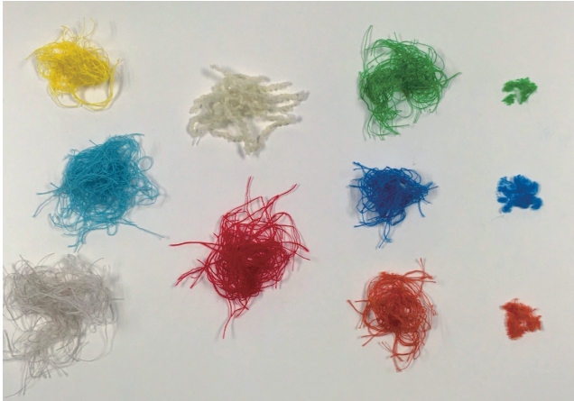
図8：解体 生地耳から抜いた緯糸
